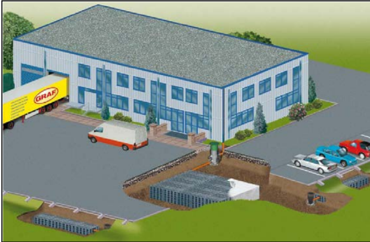
Figur 33. Exempel på utjämningsmagasin bestående av dagvattenkassetter (Uponor)
